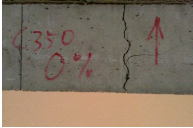
الشكل 8-4: صورة لجائز من خرسانة بدون ألياف بعد الاختبار
