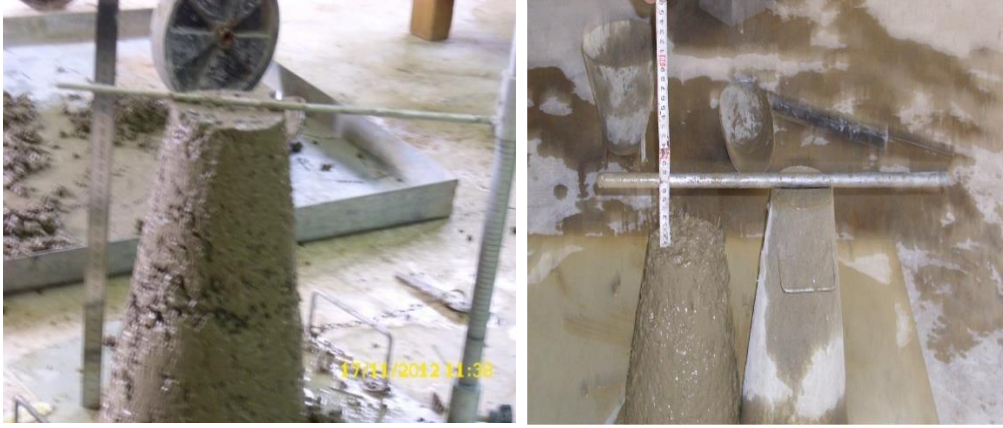
الشكل 5-5: هبوط المخروط لخلطات بدون ملدن
