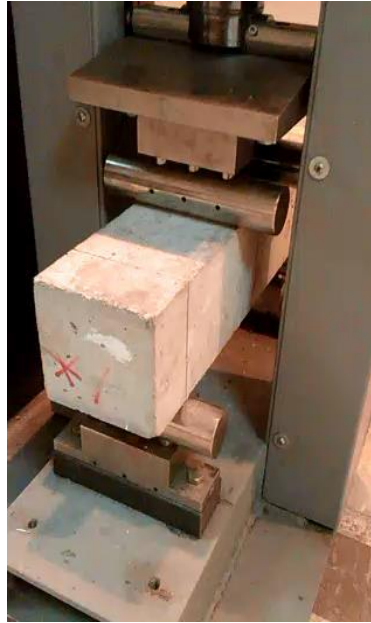
الشكل 8-3: طريقة اختبار الجوائز
