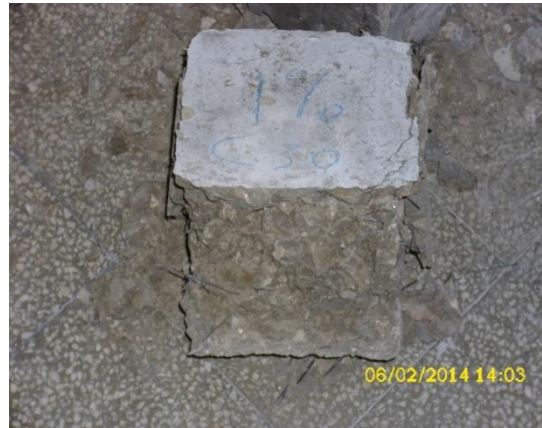
الشكل 10-5: شكل الإنهيار لعينة خرسانية عادية وعينة بألياف
