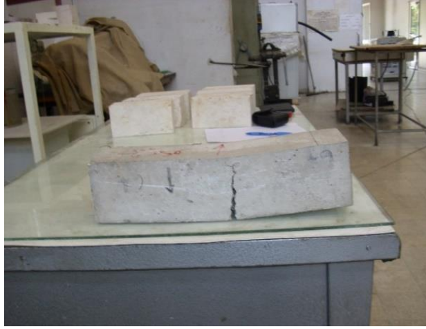
الشكل 8-5: جائز من خرسانة بألياف بعد الاختبار
