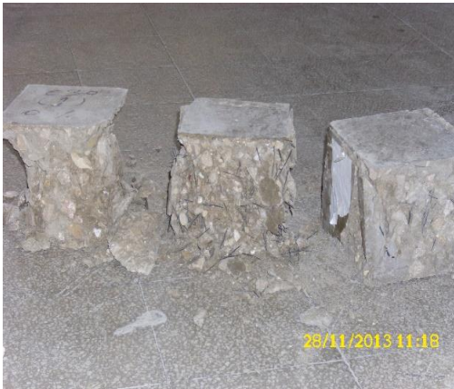
الشكل 10-5: شكل الإنهيار لعينة خرسانية عادية وعينة بألياف
