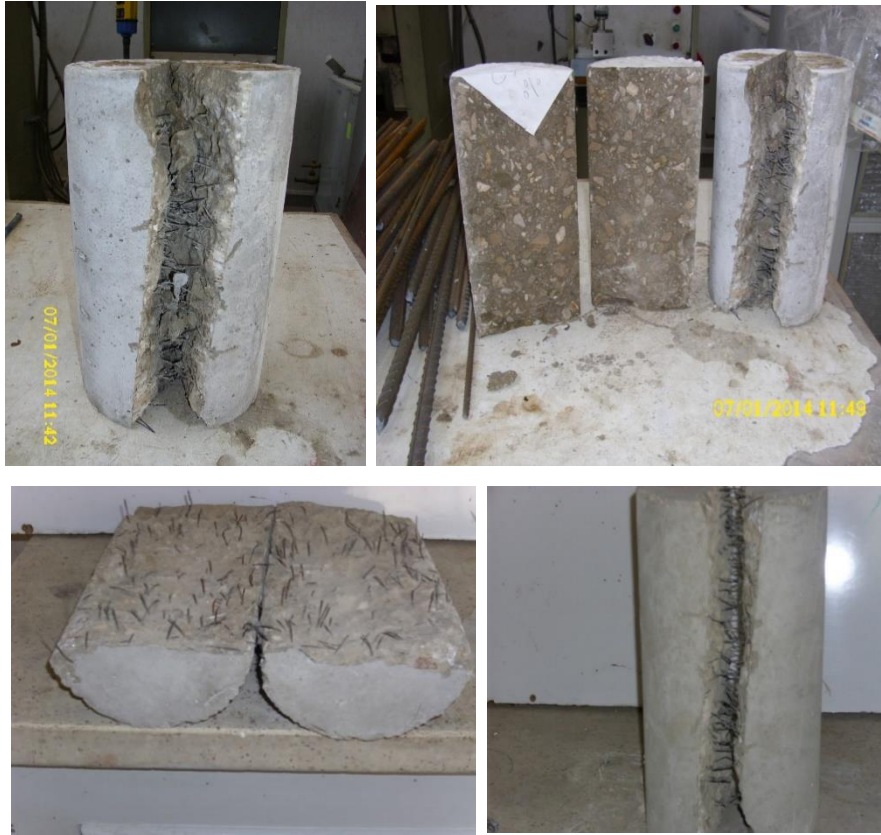
الشكل 8-2: صور تبين تماسك عينة بالألياف مختبرة على الفلق وعينة مرجعية بدون الياف
